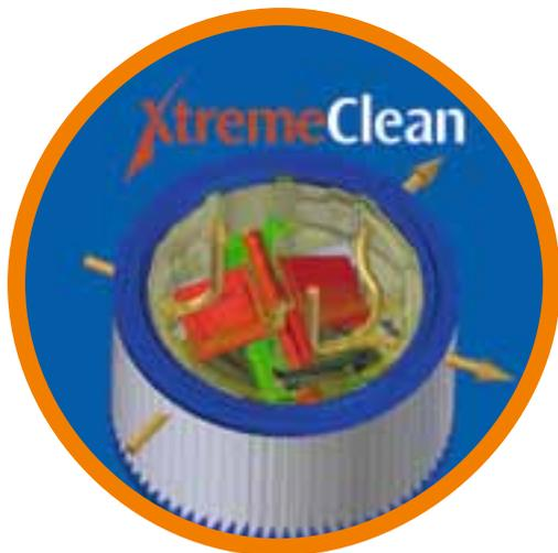
**Filterabreinigung auf hohem Niveau durch eine servomotorgesteuerte Y-Klappe – XtremeClean Technologie.**
