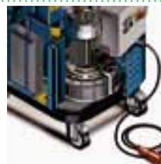
Der Seitenkanalverdichter ist aus Aluminiumdruckguss hergestellt und auf der Grundplatte des Gehäuses befestigt. Somit gibt er der Maschine mehr Stabilität. Das Lüftungsrad wird direkt angetrieben und verringert somit die Wartungskosten.
