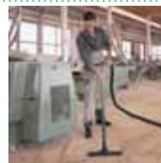
Alle Geräte der M-Klasse werden mit einem antistatischen Schlauch ausgeliefert, um Stromschläge zu vermeiden. So werden auch elektrostatische Anziehungskräfte ausgeschaltet, welche die Verschmutzung des Saugschlauches verstärken.
