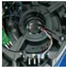
Der EC-Motor ist ein bürstenloser, langlebiger Motor. Ein verschleißarmer Betrieb und die zündquellenfreie Bauweise sind nur zwei von vielen Vorteilen.
