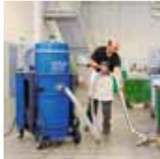
Die Industriestaubsauger ATTIX 145 und 155 verfügen über einen leistungsfähigen Seitenkanalverdichter für anspruchsvolle Reinigungsarbeiten im Maschinenbau sowie in der Keramik-, Lebensmittel- und Chemieindustrie. Dank ihrer Ganzstahlkonstruktion ist die Maschine nicht nur robust und zuverlässig, sondern sie ist auch sehr beweglich und verfügt über ein großes Behältervolumen sowie umfassende Aufbewahrungsmöglichkeiten.
