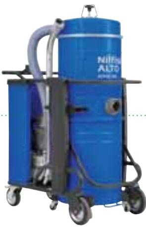
Die ATTIX 145 und 155 sind die Industriesauger zur Entfernung von Flüssigkeiten und Feststäuben, mit einer exzellenten Leistung – ausreichend für alle möglichen Reinigungs- und Wartungsarbeiten. Ausgeführt mit einem 2,2 bzw. 4,0 kW starken Seitenkanalverdichter garantieren sie eine wartungsfreie zuverlässige Wirkung 24 Stunden am Tag.
